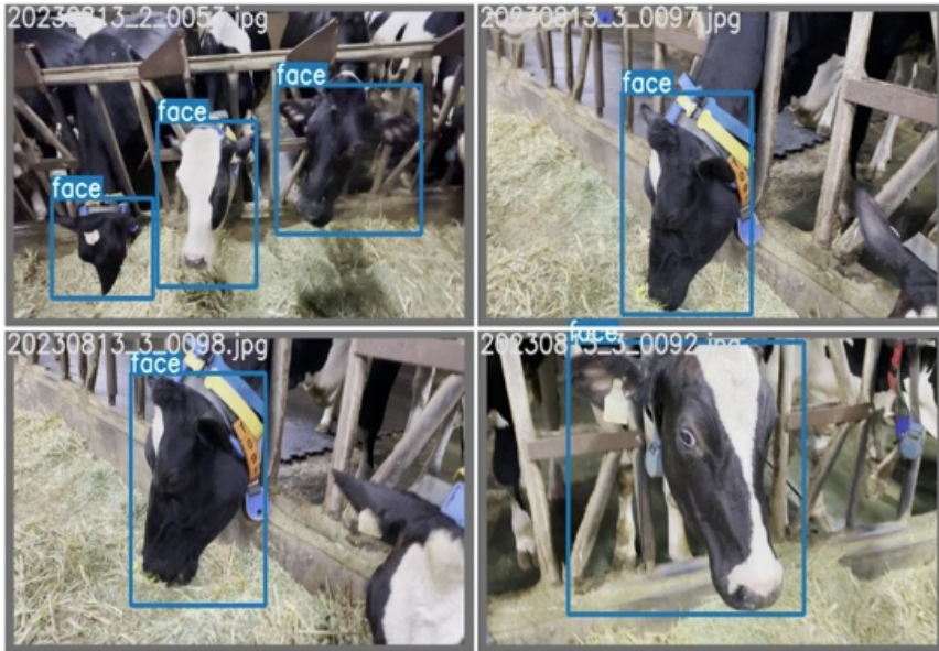
牛臉偵測模型展示，圖中可觀察到該模型在面對多個角度的牛臉影像皆可成功辨識
