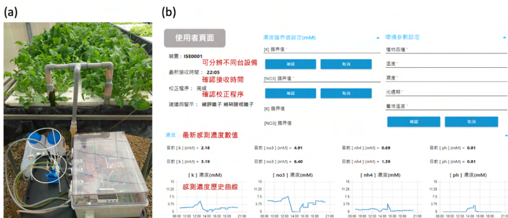
圖一、(a) 系統養液自動監測系統於溫室內架設圖。(b) 即時遠程監控使用者介面。
