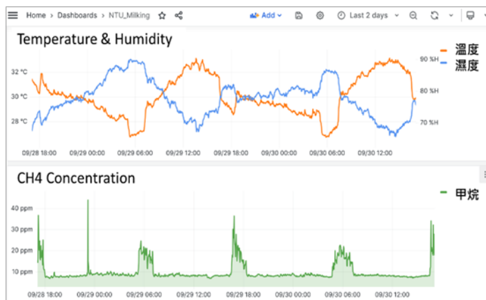
圖2 甲烷濃度與溫濕度之即時監控介面
