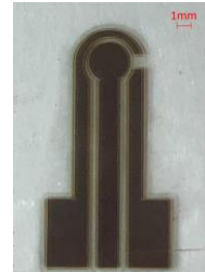
銅膜線路成型之表面型態
